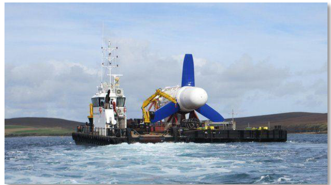
Nhiều thiết kế tuabin thủy triều tương tự như tuabin gió, dùng dòng hải lưu để vận hành các cánh quạt.
