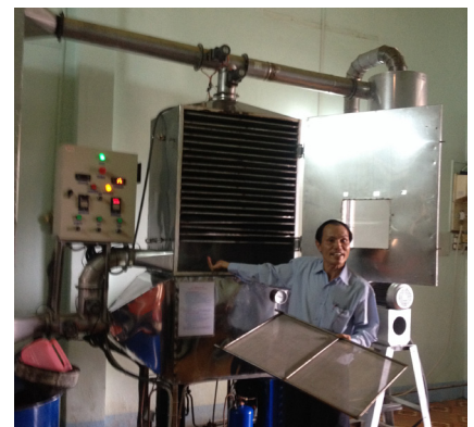
TS. Vũ Kế Hoạch (chủ nhiệm đề tài) thuyết minh về hệ thống buồng sấy của máy sấy đa năng các sản phẩm ong mật. Ảnh: VN.
